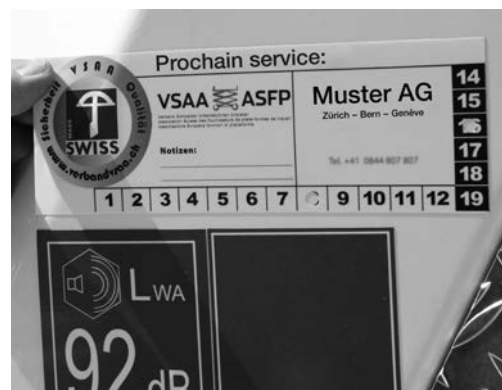
Fig. 4: la date des prochains travaux de maintenance peut être indiquée sur une plaquette apposée sur l'engin.
