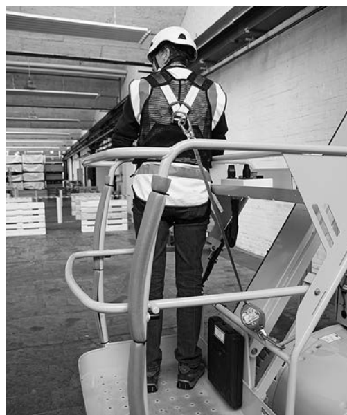
Fig. 1: les PEMP à élévation multidirectionnelle présentent un risque de chute accru. Chaque personne intervenant sur la plateforme doit être munie d'un système de retenue (harnais antichute et longes réglables d'au max. 1,8 m) et d'un casque de protection avec jugulaire.
